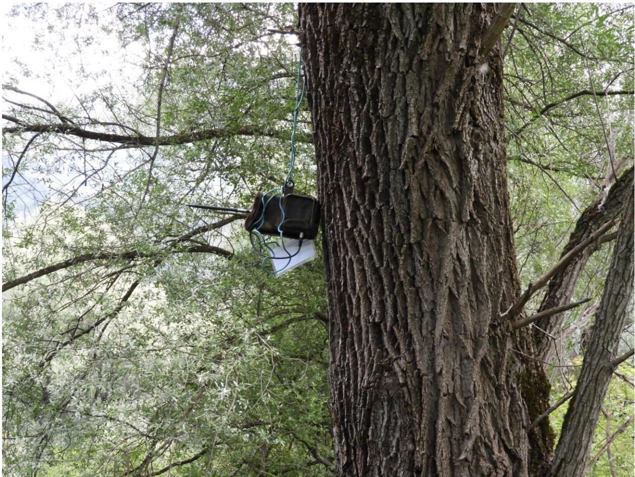
Abbildung 2: Batcorder der Firma ecoObs (Abmessungen je nach Modell 18x11 bzw. 15x9 cm zuzüglich omnidirektionalem Mikrofon etwa 15 cm) zur Erfassung und Speicherung von Fledermausrufen mit Hilfe einer Leiter befestigt in etwa 4 Meter Höhe.
