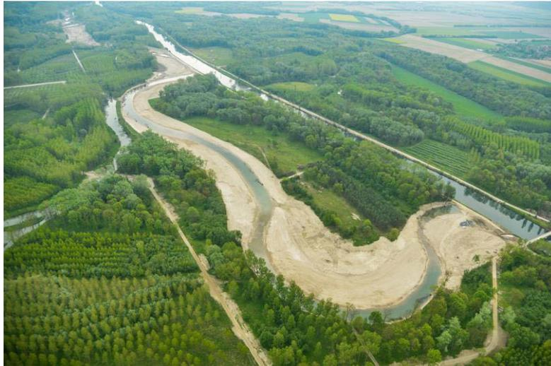
Abb. 11: Luftaufnahme des BA1 kurz vor der Fertigstellung 2014 (Durchstich und Abdämmung des begradigten Traisenflusslaufs noch ausständig) (Verbund 2014).
