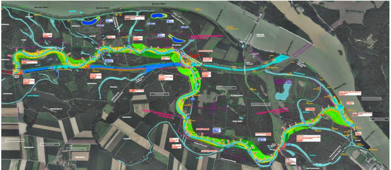
Abb. 4: Plan der neuen Traisen für die Umsetzungsphase nach Projektänderung
