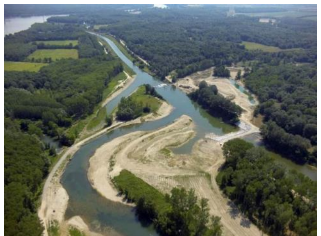
Abb. 15: unterer Teil BA Mitte Ost (links) und Rückmündung in die bestehende Traisen mit Umlandabsenkung und Überfahrt über bestehende Traisen (rechts) am 2.7.15 (Fotos Pock).
