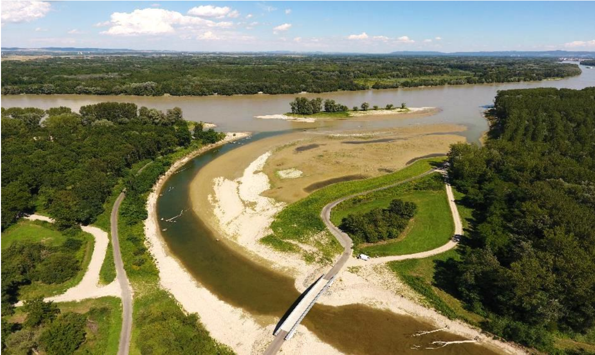
Abb. 22: Die neue Traisen-Mündung im Juli 2016 bei erhöhtem Donauwasserstand. Im Flussbett der Traisen befindet sich nur Grundwasser oder rückgestautes Donauwasser, da der flussauf liegende Bauabschnitt 3 noch nicht an den Fluss angebunden ist. Gut zu sehen die neue Radwegbrücke und der verlegte Donauradweg. (Foto Pock).
