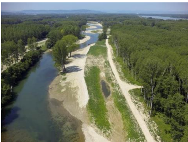
Abb. 15: unterer Teil BA Mitte Ost (links) und Rückmündung in die bestehende Traisen mit Umlandabsenkung und Überfahrt über bestehende Traisen (rechts) am 2.7.15 (Fotos Pock).
