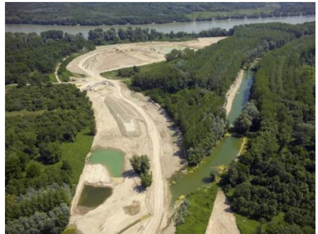
Abb. 16: Aushub von Kies und beginnende Verfüllung der Umlandabsenkung im mündungsnahen Bereich des BA Ost (FI-Km 0,4) am 2.7.15 (links) und Korridor mit teilausgehobener Umlandabsenkung bei der Querung der Eisteiche bis mündungsnaher Bereich am 2.7.15 (rechts, Fotos G.Pock)
