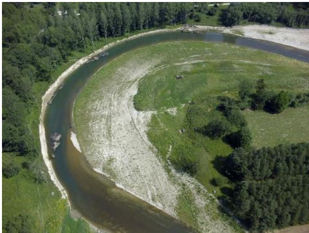
Abb. 12: Prallufer (links) und Rückmündung inkl. Umlandabsenkung und Stillwasserbiotopen (rechts) BA Mitte West am 2.7.15 (Fotos Pock)
