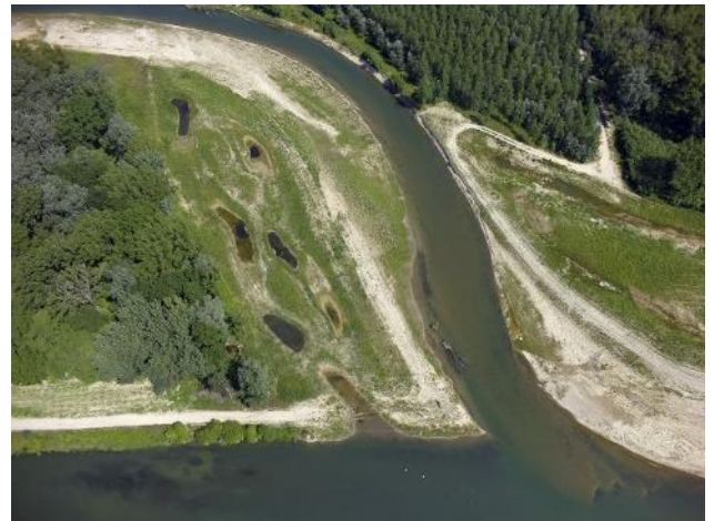
Abb. 12: Prallufer (links) und Rückmündung inkl. Umlandabsenkung und Stillwasserbiotopen (rechts) BA Mitte West am 2.7.15 (Fotos Pock)
