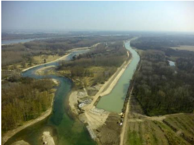
Abb. 13: oberer Teil BA Mitte Ost mit Ausleitungs-Bauwerk No.3 (links) und mittlerer Teil mit Einmündung des Saumwassers (rechts) kurz nach Flutung 10.4.2015 (Fotos Pock)
